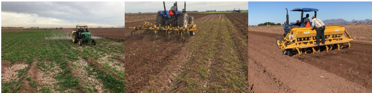
Figura 1. De izquierda a derecha; aplicación de desecante, escarificación y siembra de trigo.
