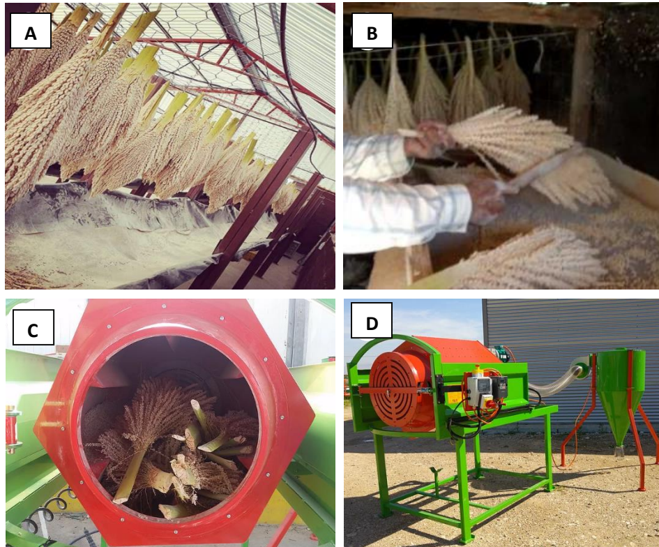
Figura 1. Extracción de polen: A) Secadero de inflorescencias masculinas de palma datilera. B) Extracción mediante golpes suaves a la inflorescencia. C) Inflorescencias dentro de una maquina extractora de polen. D) Vista lateral de un equipo completo extractor de polen.
